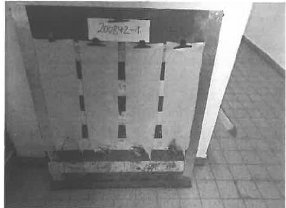
**2.3 Normalentflammbarkeitsprüfung nach DIN 4102-1**
