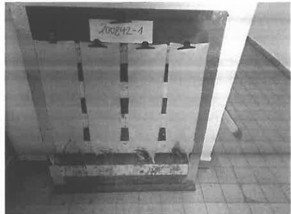
**2.3 Normalentflammbarkeitsprüfung nach DIN 4102-1**
